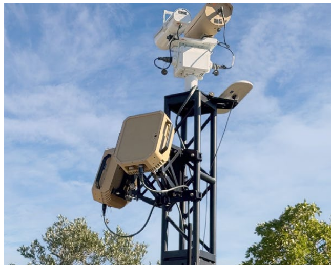
OWT Global 開發的 EchoShield 雷達展示系統。
