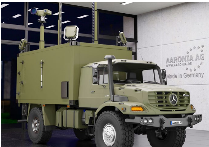
EchoShield 雷達為行動任務 (OTM) 的應用車載部署配置。
