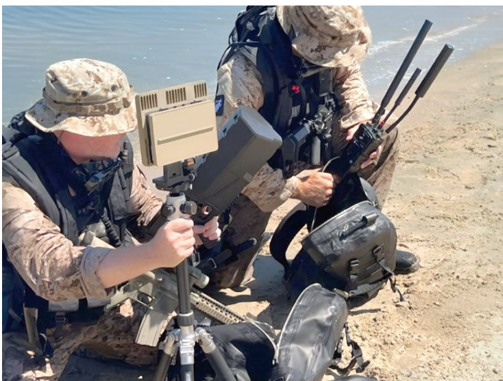
EchoGuard 的高便攜性能在 ISR (情報監視偵察) 系統上作為主要感應器。
